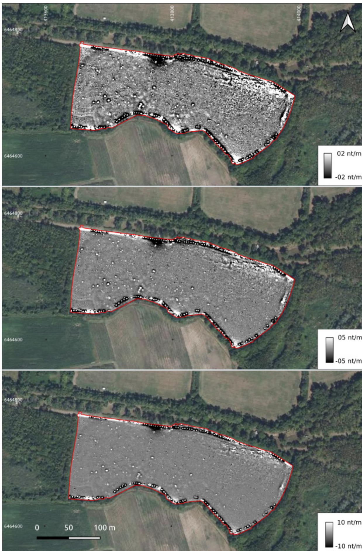
Figure 07 : Cartes du gradient magnétique mesuré en nT/m (DAO : R. Lopes)
