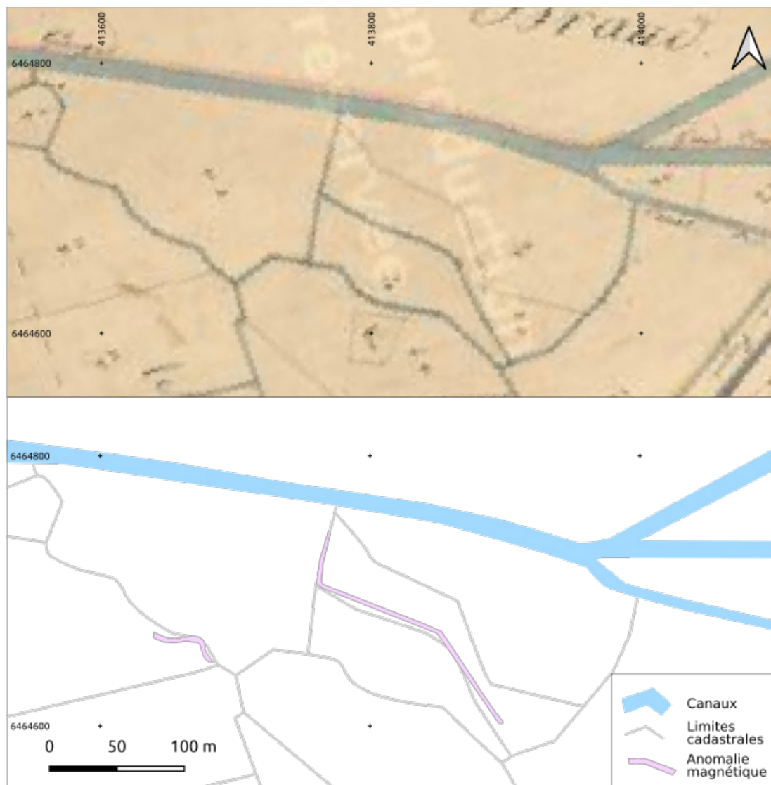
Figure 10 : Deux anomalies magnétiques linéaires positives superposées au cadastre napoléonien (DAO : R. Lopes)
